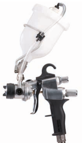
I materiali viscosi sottili vengono nebulizzati sull'ugello solo per gravità e vuoto. La figura mostra una tazza a gravità con possibilità di alimentare aria compressa aggiuntiva dall'alto per materiali altamente viscosi (foto: Walther Pilot)
