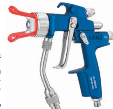
Nella spruzzatura Airless la vernice viene nebulizzata sull'apposito ugello senza l'ausilio dell'aria compressa (foto: SATA GmbH & Co. KG. A questa pistola volendo si può allacciare aria compressa per ottenere una nebulizzazione ancor più fine).
