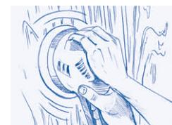
**2.** Avant de procéder au vernissage de l'objet, il convient de poncer le bois soigneusement et progressivement. Il est recommandé de poncer le bois à rénover jusqu'au bois brut. Commencez avec un papier abrasif d'un grain de P100 ou P120. Pour un résultat impeccable, plusieurs étapes de ponçage sont nécessaires. Nous recommandons d'utiliser un grainage de plus en plus fin de 60 à 80 entre chaque étape jusqu'au ponçage final (P180/P240/P320). Puis éliminez la poussière de bois de la surface.
