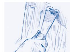
**1.** En premier lieu, examinez soigneusement l'objet à rénover afin de réparer tous les défauts. Les trous, fissures et rayures profondes peuvent facilement être garnis avec du bouche-pores. Utilisez une spatule adaptée et appliquez le bouche-pores (p.ex. le bouche-pores pour bois Correct de Zweihorn®) dans le défaut. Puis lissez- le pour éliminer tout surplus afin de faciliter le ponçage ultérieur.
