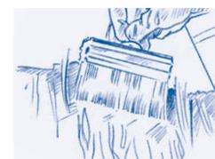
**3.** Versez d'abord le vernis dans un récipient propre et adapté. En fonction de l'objet à traiter, utilisez un pinceau rond ou plat avec des poils souples et propres. Appliquez le vernis dans le sens des veines du bois puis perpendiculairement aux veines et pour égaliser ensuite à nouveau dans les sens des veines.
