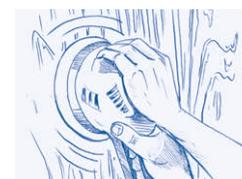
**2.** Avant de procéder au vernissage de l'objet, il convient de poncer le bois soigneusement et progressivement. Il est recommandé de poncer le bois à rénover jusqu'au bois brut. Commencez avec un papier abrasif d'un grain de P100 ou P120. Pour un résultat impeccable, plusieurs étapes de ponçage sont nécessaires. Nous recommandons d'utiliser un grainage de plus en plus fin de 60 à 80 entre chaque étape jusqu'au ponçage final (P180/P240/P320). Puis éliminer la poussière de bois de la surface.
