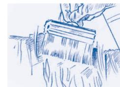
**3.** Versez d'abord le vernis dans un récipient adapté et propre. En fonction de l'objet à traiter, utilisez un pinceau rond ou plat avec des poils souples et propres. Appliquez le vernis dans le sens des veines du bois puis perpendiculairement aux veines et pour égaliser ensuite à nouveau dans le sens des veines.
