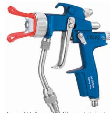
Avec la pulvérisation Airless, la pulvérisation du vernis se fait au niveau de la buse de pulvérisation sans aide d'air comprimé (Photo : SATA GmbH & Co. KG. Pour ce pistolet, on peut facultativement ajouter de l'air comprimé pour une pulvérisation encore plus fine.)
