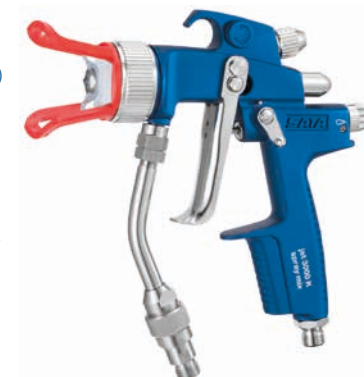
Ved airless-sprøjtning sker forstøvningen af lakken ved forstøverdysen uden understøttelse af trykluft (foto: SATA GmbH & Co. KG. Der kan tilsluttes trykluft til denne pistol for at få en finere forstøvning.)
