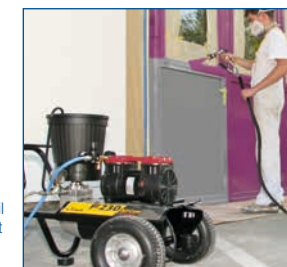
Ved airless-sprøjtning sker forstøvningen af lakken ved forstøverdysen uden understøttelse af trykluft (foto: SATA GmbH & Co. KG. Der kan tilsluttes trykluft til denne pistol for at få en finere forstøvning.)
