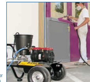
Beim Airless-Spritzen erfolgt die Zerstäubung des Lackes an der Zerstäuberdüse ohne die Unterstützung von Druckluft (Foto: SATA GmbH & Co. KG. Bei dieser Pistole kann Druckluft zur noch feineren Zerstäubung optional angeschlossen werden.)
