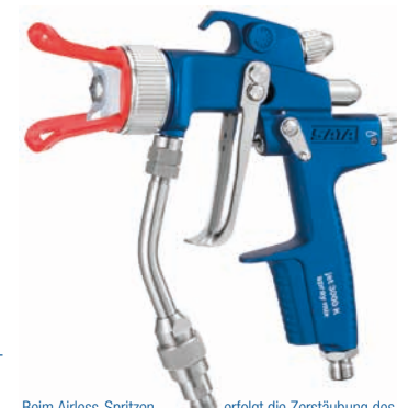
Beim Airless-Spritzen erfolgt die Zerstäubung des Lackes an der Zerstäuberdüse ohne die Unterstützung von Druckluft (Foto: SATA GmbH & Co. KG. Bei dieser Pistole kann Druckluft zur noch feineren Zerstäubung optional angeschlossen werden.)
