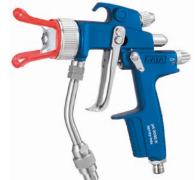
Při bezvzduchovém stříkání (Airless) se rozprašování laku realizuje na rozprašovací trysce bez podpory stlačeného vzduchu (foto: SATA GmbH & Co. KG. Při této pistolí může být pro ještě jemnější rozprašování alternativně připojen stlačený vzduch.)
