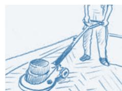
**4.** Lavorare poi immediatamente l'olio residuo a mano (con uno straccio) o con una macchina monodisco con pad bianco o verde, finché la superficie risulta asciutta.
