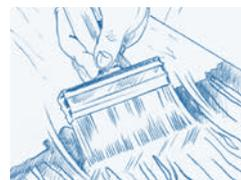
**2.** Prima dell'uso rimestare o sbattere ben bene l'olio. Applicare uniformemente NHWO umido con un pennello resistente all'olio o un rullo, fino a saturazione. La penetrazione dell'olio dipende dal tipo di legno. Nei punti dove esso appare secco si deve subito rioliare finché l'olio si deposita uniformemente sulla superficie. Iniziate lavorando in zone lontane dalla luce, per vedere subito dove l'olio penetra più rapidamente e dove quindi bisogna rioliare.
