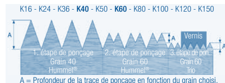
Surface vernie après ponçage avec une succession de grains adaptée.
