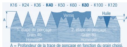
Surface vernie et huilée montrant des défauts après ponçage avec une succession de grains non adaptée.
