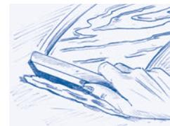
3. Nach einer Wartezeit von ca. 30 Minuten muss das überschüssige Öl komplett abgenommen werden! Ziehen Sie die Fläche hierzu am besten mit einem sauberen, nicht abfärbenden Gummirakel oder Fensterwischer ab (Es darf kein Öl mehr auf der Fläche sichtbar stehen bleiben!) und lassen Sie anschließend die Fläche über Nacht trocknen. Bei Bedarf können Schritt 2 und 3 wiederholt werden.
