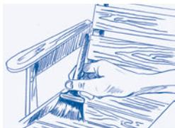
**2.** Für einen wetterfesten Aufbau wird Naturtrend NHDO dünn aufgetragen, ohne das Öl anschließend abzunehmen. Hierbei das NHDO gleichmäßig verteilen und dabei den Pinsel zwischendurch auf einem Tuch abtupfen, um überschüssiges Öl von der Fläche zu nehmen. Lassen Sie die Fläche über Nacht trocknen und wiederholen Sie den Vorgang. Für ein witterungsbeständiges Ergebnis empfehlen wir, drei Aufträge vorzunehmen.
