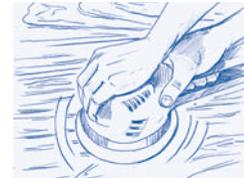
1. Bevor Sie mit dem Wachsen beginnen, müssen Sie die Fläche, wie in Kapitel 2 (Vorbereitung) beschrieben, schleifen. Befreien Sie die Fläche anschließend vom Holzstaub. Bei beanspruchten Oberflächen, wie Tischen, Arbeitsplatten, Holzböden oder Treppenstufen sowie Deckenverkleidungen bei Feuchtraumeinrichtungen (Bäder, Küchen) empfehlen wir die Vorbehandlung mit den Naturtrend Ölen NHO, NPO oder NHWO. Für farbige Oberflächen zuerst Naturtrend Holzdesign-Öl NHDO auftragen (s. Seite 34/35).
