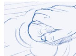
2. Arbeiten Sie das NBW mit einem Pinsel, einer Bürste oder einem flusenfreien Tuchballen gleichmäßig in die Fläche ein. Dabei das Wachs erst quer, dann längs zur Holzstruktur verteilen. Bei der Verwendung eines Tuchballens in kreisenden Bewegungen einmassieren.
