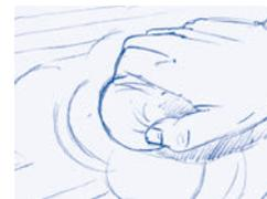
2. Arbeiten Sie das NHW mit einem etwas härteren Pinsel, einer Bürste oder einem flusenfreien Tuchballen gleichmäßig dünn in die Fläche ein. Dabei das Wachs erst quer, dann längs zur Holzstruktur verteilen. Bei der Verwendung eines Tuchballens in kreisenden Bewegungen einmassieren.
