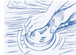
1. Bevor Sie mit dem Wachsen beginnen, müssen Sie die Fläche, wie in Kapitel 2 (Vorbereitung) beschrieben, schleifen. Befreien Sie die Fläche anschließend vom Holzstaub. Bei beanspruchten Oberflächen wie Tischen, Arbeitsplatten, Holzböden oder Treppenstufen sowie bei Feuchtraumeinrichtungen (Bäder, Küchen) empfehlen wir die Vorbehandlung mit den Naturtrend Ölen NHO, NPO oder NHWO. Für farbige Oberflächen zuerst Naturtrend Holzdesign-Öl NHDO auftragen (s. Seite 34/35).
