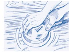
1. Bevor Sie mit dem Ölen beginnen, müssen Sie die Fläche, wie in Kapitel 2 (Vorbereitung) beschrieben, schleifen. Befreien Sie die Fläche anschließend vom Holzstaub.
