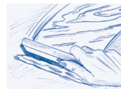
**3.** Nach einer Wartezeit von ca. 10-15 Minuten muss das überschüssige Öl komplett abgenommen werden! Ziehen Sie die Fläche hierzu am besten mit einem sauberen, nicht abfärbenden Gummirakel oder Fensterwischer ab (Es darf kein Öl mehr auf der Fläche sichtbar stehen bleiben!).
