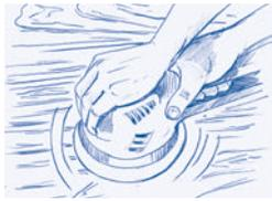
**1.** Bevor Sie mit dem Ölen beginnen, müssen Sie die Fläche, wie in Kapitel 2 (Vorbereitung) beschrieben, schleifen. Befreien Sie die Fläche anschließend vom Holzstaub. Algen, Fett, Schmutz und sonstige Verunreinigungen sollten mechanisch mit einem Pad, Schleifschwamm oder Schleifpapier entfernt werden. Bereits verwittertes Holz sollte ebenfalls gründlich abgeschliffen werden, bis es sein natürliches Aussehen zurückerhält.
