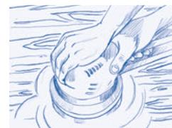
**4.** Nach Trocknung über Nacht nehmen Sie einen leichten Zwischenschliff (320er/400er Körnung oder mit einem feinen Schleifschwamm) vor und tragen NHWO nochmals dünn auf und polieren es mittels eines Exzenterschleifers mit weißem Pad ein.
