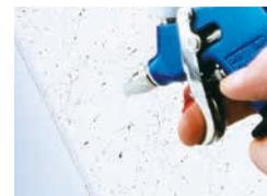
5. Applicare adesso sull'area ritoccata una mano di vernice trasparente "originale" (nell'esempio, Crystallit® Vernice CL 8) senza creare accumuli. Per garantire una finitura uniforme, la vernice deve essere applicata con la massima quantità di diluenti (fare riferimento alla scheda tecnica disponibile su [www.zweihorn.com](http://www.zweihorn.com)).
