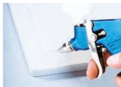
**1.** Applicate sull'area danneggiata una sottile mano di pittura colorata "originale" (nell'esempio, Wigranit® Novacolor R9016). Lavorate una piccola quantità di materiale per volta. È preferibile raggiungere la saturazione di colore originale poco a poco.
