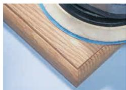
3. Una volta che il prodotto è sufficientemente asciutto, potete passare alla carteggiatura dell'area. Nel caso in cui siano ancora visibili delle piccole imperfezioni (bolle d'aria/crepe), riempite nuovamente l'ammaccatura.
