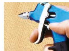
3. In caso di superfici sottoposte ad uso intensivo, si raccomanda di verniciare l'area con la vernice trasparente "originale" (nell'esempio, Crystallit® Vernice CL 8). Per garantire una finitura uniforme, la vernice deve essere applicata con la massima quantità di diluente (fare riferimento alla scheda tecnica disponibile su [www.zweihorn.com](http://www.zweihorn.com)).
