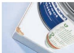
**1.** Prepare l'angolo all'intervento con del nastro adesivo per mascherature. Miscelate Correct Mastice a due componenti per legno 100:3 con la pasta indurente. Assicuratevi che il rapporto di miscelazione sia sempre corretto e che riempitivo e indurente siano miscelati omogeneamente.
