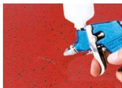
3. Applicate adesso sull'area ritoccata una mano di vernice trasparente "originale" (nell'esempio, Crystallit® Vernice CL 8) senza creare accumuli. Per garantire una finitura uniforme, la vernice deve essere applicata con la massima quantità di diluenti (fare riferimento alla scheda tecnica disponibile su [www.zweihorn.com](http://www.zweihorn.com)).
