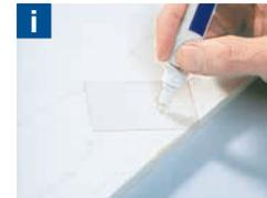
**1.** Scegliete Correct Matita coprente e velante nel colore corrispondente. Presso il rivenditore è possibile riempire Correct Matita coprente e velante con qualsiasi mordente o pittura colorata della stessa identica tonalità. Posizionate la punta della matita su un pezzo di legno di scarto (ad esempio) e premete 3-4 volte finché la punta non si riempie completamente di prodotto. La matita è ora pronta all'uso.
