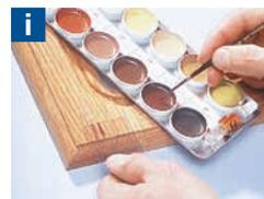
6. Potete correggere la tonalità di colore e riprodurre le venature mancanti utilizzando Correct Cassetta per ritocchi. La traslucenza, o l'opacità, del colore dipenderà dal grado di diluizione.
