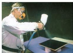
2. A questo punto verniciate l'area utilizzando la vernice adeguata (nell'esempio, Crystallit® Vernice CL 8).
