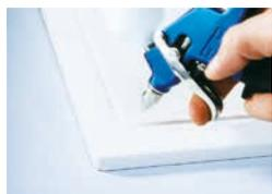
**2.** Applicate adesso sull'area ritoccata una mano di vernice trasparente "originale" (nell'esempio, Crystallit® Vernice CL 8) senza creare accumuli. Per garantire una finitura uniforme, la vernice deve essere applicata con la massima quantità di diluente (fare riferimento alla scheda tecnica disponibile su [www.zweihorn.com](http://www.zweihorn.com)).
