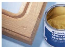
1. Individuate la tonalità di colore corretta di Correct Mastice per legno. Se avete bisogno di un colore intermedio, potete eventualmente miscelare più tonalità di colore.
