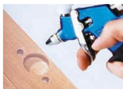
4. Applicate adesso sull'area ritoccata una mano di vernice trasparente "originale" (nell'esempio, Crystallit® Vernice CL 8) senza creare accumuli. Per garantire una finitura uniforme, la vernice deve essere applicata con la massima quantità di diluenti (fare riferimento alla scheda tecnica disponibile su [www.zweihorn.com](http://www.zweihorn.com)).
