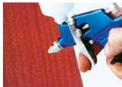
**3.** Per proteggere l'area dove è stata applicata la cera morbida, applicate una mano di vernice trasparente "originale" (nell'esempio, Crystalit® Vernice CL 8) senza creare accumuli. Per garantire una finitura uniforme, la vernice deve essere applicata con la massima quantità di diluenti (fare riferimento alla scheda tecnica disponibile su [www.zweihorn.com](http://www.zweihorn.com)).
