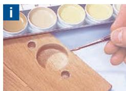
3. Potete correggere la tonalità di colore e riprodurre le venature mancanti utilizzando Correct Cassetta per ritocchi. La traslucenza, o l'opacità, del colore dipenderà dal grado di diluizione.
