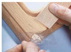
2. Riempite l'ammaccatura con Correct Mastice per legno. Le ammaccature profonde o larghe devono essere riempite in due fasi separate, lasciando asciugare il prodotto tra un'applicazione e l'altra.
