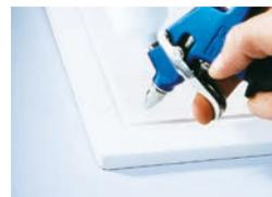
**2.** Die retuschierte Stelle muss nun mit dem „Original“-Klarlack (im Beispiel Crystallit® 2K-PUR Klarlack CL 8) „ansatzlos“ lackiert werden. Um ansatzfrei lackieren zu können, muss der Lack mit der maximalen Verdünnernzugabe appliziert werden (siehe Technisches Merkblatt unter [www.zweihorn.com](http://www.zweihorn.com)).
