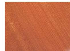
**3.** In den meisten Fällen ist durch diese einfache Anwendung der Fleck verschwunden. Ist jedoch Wasser durch eine Beschädigung der Lackschicht ins Holz gelangt, ist meist das Holz vergraut. Hier hilft nur noch abschleifen und neu lackieren!
