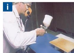
**3.** Nun können Sie die Fläche z. B. beizen und grundieren und nach dem entsprechenden Zwischenschliff endlackieren.
