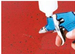
3. Die retuschierte Stelle muss nun mit dem „Original“-Klarlack (im Beispiel Crystallit® 2K-PUR Klarlack CL 8) „ansatzlos“ lackiert werden. Um ansatzfrei lackieren zu können, muss der Lack mit der maximalen Verdünnungszugabe appliziert werden (siehe Technisches Merkblatt unter [www.zweihorn.com](http://www.zweihorn.com)).
