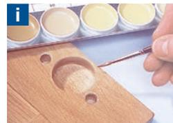
**3.** Farbtonkorrekturen und fehlende Adern können Sie einfach mit dem Correct Tuschkasten CTK herstellen. Stark verdünnt wirken die Farben lasierend, weniger verdünnt deckender.
