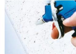
5. Die retuschierte Stelle muss nun mit dem „Original“-Klarlack (im Beispiel Crystallit® 2K-PUR Klarlack CL 8) „ansatzlos“ lackiert werden. Um ansatzfrei lackieren zu können, muss der Lack mit der maximalen Verdünnung abgezogen werden (siehe Technisches Merkblatt unter [www.zweihorn.com](http://www.zweihorn.com)).
