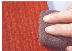
4. Eventuell entstandenen Sprühnebel mit feiner Stahlwolle (000) oder weißem Schleifvlies entfernen. Hierbei mit wenig Druck arbeiten, um keine Schleifspuren zu verursachen.
