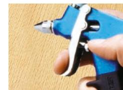
**3.** Bei beanspruchbaren Flächen empfiehlt sich eine Lackierung der beschädigten Stelle mit dem „Original“-Klarlack (im Beispiel Crystallit® 2K-PUR Klarlack CL 8). Um ansatzfrei lackieren zu können, muss der Lack mit der maximalen Verdünnernzugabe appliziert werden (siehe Technisches Merkblatt unter [www.zweihorn.com](http://www.zweihorn.com)).
