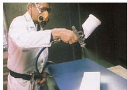
4. Füllen Sie die Fläche z. B. mit Wigranit® 2K-PUR Isolierfüller IF. Bei furnierten oder massiven Holzflächen würde hier gebeizt, grundiert oder gegebenenfalls fehlende Poren nachgezogen.
