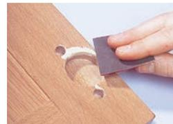
**2.** Schleifen Sie nur die Schadenstelle, um die aufwändigen Retuschierarbeiten auf ein kleines Feld zu begrenzen. Fehlende Poren können Sie jetzt mit der Spitze einer Ziehklinge nachziehen. Um dunkle Poren nachzustellen, können Sie sie mit dunklem Weichwachs verfüllen.
