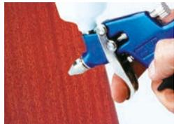
3. Zum Schutz der Weichwachs-Fläche sollten Sie die Stelle mit dem „Original“-Klarlack (im Beispiel Crystallit® 2K-PUR Klarlack CL 8) „ansatzlos“ lackieren. Um ansatzfrei lackieren zu können, muss der Lack mit der maximalen Verdünnerzugabe appliziert werden (siehe Technisches Merkblatt unter [www.zweihorn.com](http://www.zweihorn.com)).
