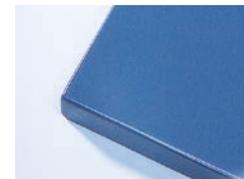
7. Nach entsprechendem Zwischenschliff wird die Buntlackfläche mit Crystallit® 2K-PUR Klarlack CL ablackiert. Da der Schaden vor der Lackierung behoben wird, sehen Sie nach der deckenden Lackierung nichts mehr.
