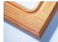
**7.** Retuschierte Stellen müssen immer überlackiert werden. Nach der entsprechenden Schlusslackierung ist die Fläche fertig.
