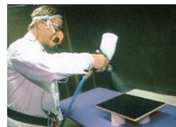
**2.** Lackieren Sie die Fläche nun mit dem entsprechenden Lack (im Beispiel Crystallit® 2K-PUR Klarlack CL 8).
