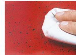
5. Sie sollten die Fläche anschließend noch von allen Verunreinigungen säubern. Wischen Sie die Oberfläche einfach mit Zweihorn® Möbelpflege MPF ab.
