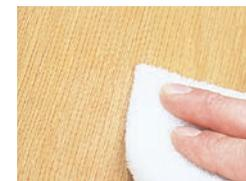
**2.** Mit dem weißen Schleifvlies können Sie bei Bedarf etwaige Farbüberlappungen egalisieren, ohne die lackierte Oberfläche zu beschädigen.
