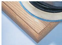
**3.** Nach ausreichender Trocknung können Sie die Stelle plan schleifen. Sollten noch kleine Löcher (Luftblasen/Risse) sichtbar sein, müssen Sie diese nochmals verfüllen.
