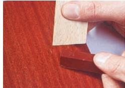
1. Füllen Sie den Kratzer mit dem Correct Weichwachs CWW im passenden Farbton. Im Bedarfsfall können Sie auch verschiedene Farbtöne miteinander mischen. Das Weichwachs lässt sich im „handwarmen“ Zustand am Besten verarbeiten.
