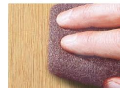
**4.** Eventuell entstandenen Sprühnebel mit feiner Stahlwolle (000) oder weißem Schleifvlies entfernen. Hierbei mit wenig Druck arbeiten, um keine Schleifspuren zu verursachen.
