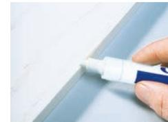
2. Ziehen Sie mit dem Stift etwas schräg zur Kante über die Schadenstelle. Sollte ein zweiter Auftrag notwendig sein, müssen Sie eine gewisse Zwischentrockenzeit einhalten!
