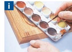
**6.** Farbtonekorrekturen und fehlende Adern können Sie einfach mit dem Correct Tuschkasten CTK herstellen. Stark verdünnt wirken die Farben lasierend, weniger verdünnt deckender.
