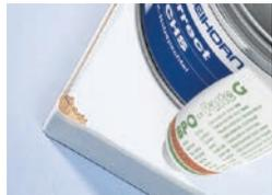
1. Kleben Sie die Ecke mit einem Klebeband ab. Mischen Sie den Correct 2K-Holzspachtel CHS mit der Härterpaste 100:3. Wichtig ist die Einhaltung des Mischungsverhältnisses und die homogene Vermengung von Spachtel und Härter.
