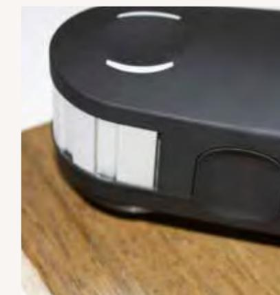
Farbmetrische Ausmessung eines gebeizten Holzusters (Eiche) mittels eines Spektralfotometers
