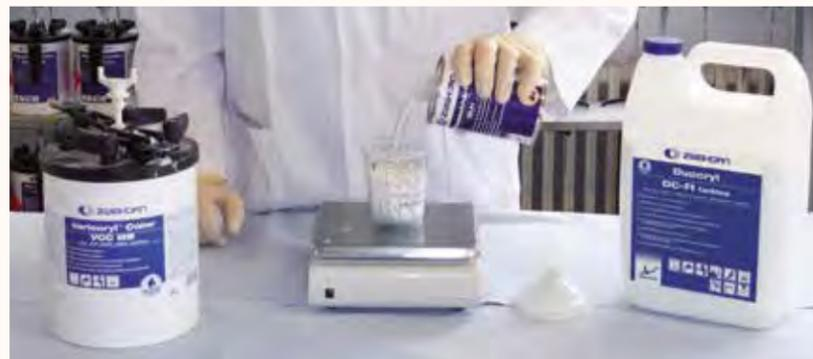
Ansetzen einer farbigen Glaslackierung auf Wasserbasis „All-in-One-Effekt“: Duocryl Klarlack DC mit 1% Variocryl® Metallic VCC/MB und 5% VCC/Weiß unter Zugabe von 20% Glaslackhärter GLH
