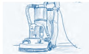
3. Nach einer Trockenzeit von ca. 60–90 Minuten kann dann der versiegelte Boden geschliffen werden. Verwenden Sie hierzu ein Tellerschleifgerät und Schleifscheiben der Körnung 150 sowie anschließend braune Schleifpads (fein). Arbeiten Sie gleichmäßig mit wenig Druck (Gefahr des Durchschleifens!). Der Boden muss überall matt sein. Saugen Sie den Boden und wischen ihn mit einem Staubbindetuch ab. Nun kann Unocryl 1K-Parkettlack UC-P oder Duocryl 2K-Parkettlack DC-P aufgetragen werden.
