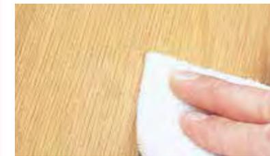
2. Mit dem weißen Schleifvlies können Sie bei Bedarf etwaige Farbüberlappungen egalisieren, ohne die lackierte Oberfläche zu beschädigen.
