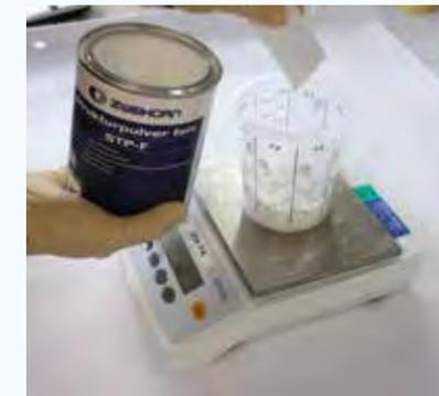
*Dem Treppenlack wird Strukturpulver STP zugegeben.*
