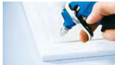
2. Die retuschierte Stelle muss nun mit dem „Original“-Klarlack (im Beispiel Crystallit® 2K-PUR Klarlack CL 8) „ansatzlos“ lackiert werden. Um ansatzfrei lackieren zu können, muss der Lack mit der maximalen Verdünnerzugabe appliziert werden (siehe Technisches Merkblatt unter [www.zweihorn.com](http://www.zweihorn.com)).
