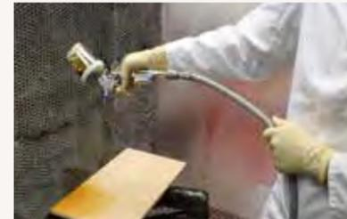
*Wird Spritz- und Pinselbeize S 9900 mit einer Becherpistole appliziert, so entsteht ein klarer, brillanter Effekt.*
