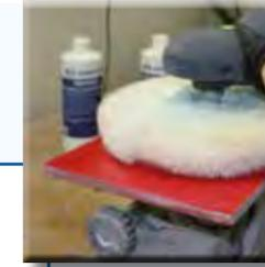
Ein Polieren der lackierten Fläche erhöht die Brillanz und beseitigt kleine Unebenheiten wie Staubeinschlüsse in der fertigen Hochglanzoberfläche.
