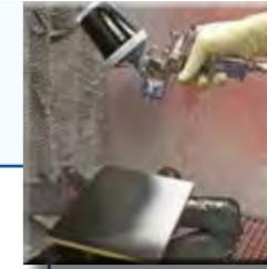
Welches Verfahren im Einzelfall angewandt wird, hängt von der Gestaltung der Werkstücke ab. Entscheidend sind hierbei das Lacksystem, die Lackkosten sowie die gewünschte Oberflächenqualität. Industrielle Beschichtungen von glattflächigen Teilen werden überwiegend im Walz- oder Gießverfahren appliziert. Profile, Leisten oder andere dreidimensionale Teile werden vorzugsweise im Spritzverfahren, im Handwerk manuell und in der Industrie automatisch mit Spritzrobotern oder Spritzanlagen veredelt.
