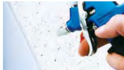
**5.** Die retuschierte Stelle muss nun mit dem „Original“-Klarlack (im Beispiel Crystallit® 2K-PUR Klarlack CL 8) „ansatzlos“ lackiert werden. Um ansatzfrei lackieren zu können, muss der Lack mit der maximalen Verdünnerzugabe appliziert werden (siehe Technisches Merkblatt unter [www.zweihorn.com](http://www.zweihorn.com)).
