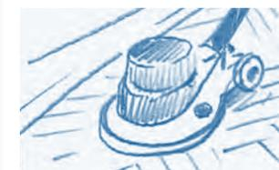
3. Massieren Sie die Fläche nach 10 Minuten Einwirkzeit mit einer Einscheiben-Schleifmaschine mit weißem Pad oder einem Tuchballen, sodass kein feuchter Ölfilm mehr zu sehen ist und die Fläche trocken erscheint. Nach der Behandlung mit Naturtrend Öl-Auffrischer NOA beträgt die Aushärtezeit mind. 24 Stunden. In dieser Zeit vor Wasser schützen! Danach mit weißem Pad nachpolieren.
