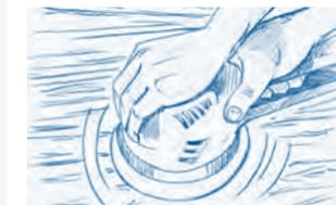
1. Bevor Sie mit dem Ölen beginnen, müssen Sie die Fläche, wie auf Seite 18 beschrieben, schleifen. Befreien Sie die Fläche anschließend vom Holzstaub.
