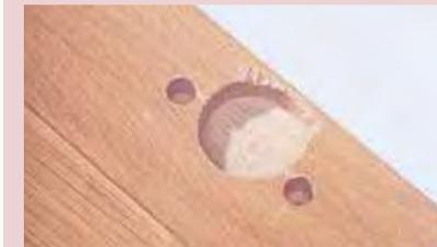
Ausgebrochenes Topfband am Beispiel einer gebeizten und lackierten Massivholz-Schranktür
