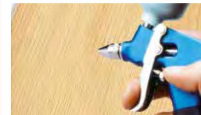
3. Bei beanspruchbaren Flächen empfiehlt sich eine Lackierung der beschädigten Stelle mit dem „Original“-Klarlack (im Beispiel Crystallit® 2K-PUR Klarlack CL 8). Um ansatzfrei lackieren zu können, muss der Lack mit der maximalen Verdünnerzugabe appliziert werden (siehe Technisches Merkblatt unter [www.zweihorn.com](http://www.zweihorn.com)).
