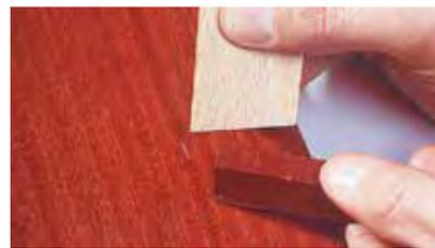
1. Füllen Sie den Kratzer mit dem Correct Weichwachs CWW im passenden Farbton. Im Bedarfsfall können Sie auch verschiedene Farbtöne miteinander mischen. Das Weichwachs lässt sich im „handwarmen“ Zustand am besten verarbeiten.
