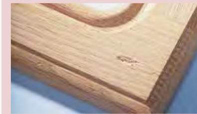
Loch/Fehlstelle am Beispiel eines rohen, massiven Holzrahmens
