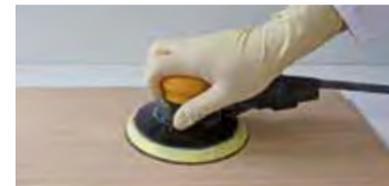
**Vorbehandlung:** Nehmen Sie einen gründlichen abgestuften Holzschliff auf dem rohen Holz vor: zuerst mit 120er-, dann mit 150er- und zuletzt mit 180er-Körnung. Anschließend den Schleifstaub bei grobporigen Hölzern durch Ausbürsten mit einer Poren- und Faserbürste entfernen.
