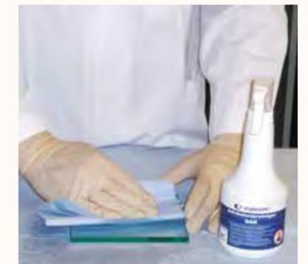
Das Glas wird mit Spezialadhäsionsreiniger SAR vorbehandelt.
