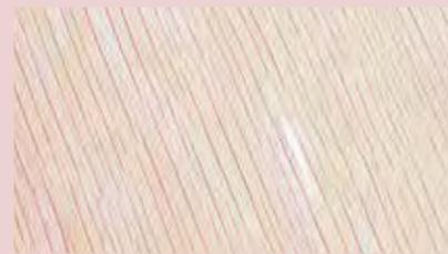
Kratzer/Fehlstelle am Beispiel einer rohen, furnierten Spanplatte
