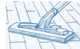
1. Bevor Sie die Behandlung mit Naturtrend Öl-Auffrischer NOA beginnen, müssen Sie den Fußboden zunächst von Staub und Schmutz befreien. Saugen Sie hierzu den Boden gründlich ab und/oder reinigen Sie ihn mit einem nebelfeuchten, flusenfreien Bodentuch. Lassen Sie die Fläche vor dem Auftrag trocknen.
