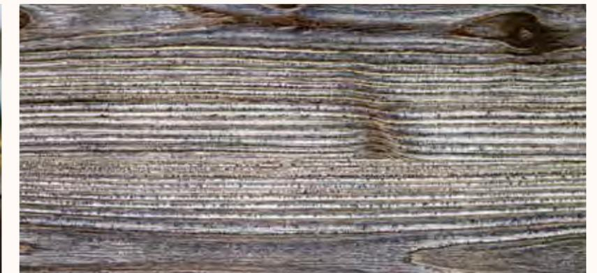
Holz strukturgebürstet mit anschließender Effektgestaltung (Verwitterung)
