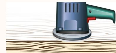
... werden durch das Schleifen geköpft. So erhält man eine glatte Oberfläche, die für ein einheitliches Beizbild bzw. eine ebene Lackoberfläche sorgt.
