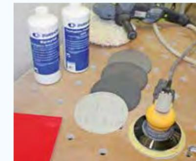
Die Polierausrüstung: feine Schleifpapiere, Schleif- und Polierpasten sowie ein Lammfellpad
