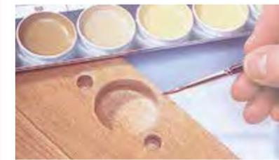
3. Farbtonkorrekturen und fehlende Adern können Sie einfach mit dem Correct Tuschkasten CTK herstellen. Stark verdünnt wirken die Farben lasierend, weniger verdünnt deckender.
