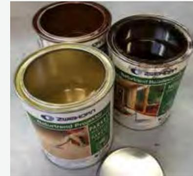
Produktreste von flüssigem Öl dürfen nicht in den Abguss oder die Mülltonne geschüttet werden. Die Gebinde müssen fest verschlossen und gekennzeichnet sein. Dabei ist zu beachten, dass unterschiedliche Produktreste nicht vermischt werden, sondern getrennt voneinander gesammelt werden. Die Gebinde sind Sonderabfall und müssen z. B. in der Sammelstelle für Sonderabfall abgegeben werden.
