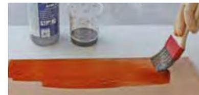
**Mit dem Pinsel:** Für den Pinselauftrag wird am besten ein Beizvertreiber mit Echthaarborsten verwendet. Dieser sollte keine Metallteile aufweisen, weil die Beize das Metall angreifen und rosten könnte. Die Beize wird mit dem Beizvertreiber in Maserrichtung satt aufgetragen. Nach kurzer Einwirkzeit zuerst quer, dann längs verreiben. Nach dem Gebrauch gut reinigen und zum Trocknen mit den Borsten nach unten aufhängen.
