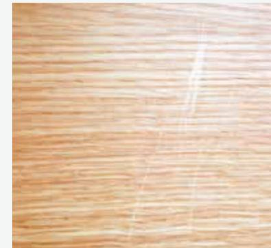
*Kratzer entstehen bei geölte Oberflächen schneller als bei lackierten.*
