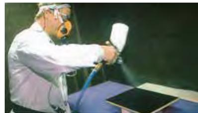
2. Lackieren Sie die Fläche nun mit dem entsprechenden Lack (im Beispiel Crystallit® 2K-PUR Klarlack CL 8).
