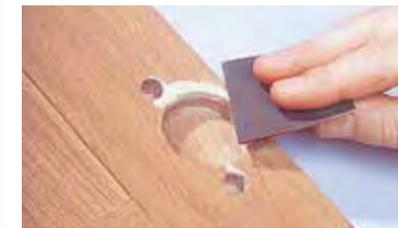
2. Schleifen Sie nur die Schadenstelle, um die aufwändigen Retuschierarbeiten auf ein kleines Feld zu begrenzen. Fehlende Poren können Sie jetzt mit der Spitze einer Ziehklinge nachziehen. Um dunkle Poren nachzustellen, können Sie sie mit dunklem Weichwachs verfüllen.
