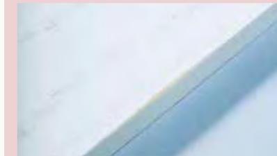
**Aufgekratzte/Durchgeschliffene Kante am Beispiel einer weiß (9016) lackierten Oberfläche**
