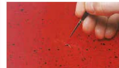
1. Füllen Sie den Kratzer mit „Original“-Buntlack (im Beispiel Wigranit® Novacolor 2K-PUR Buntlack WNC). Benutzen Sie hierzu einen der Pinsel aus dem Correct Tuschkasten.
