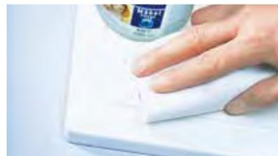
4. Sie sollten die Fläche anschließend noch von allen Verunreinigungen säubern. Wischen Sie die Oberfläche einfach mit Zweihorn® Möbelreiniger und -pflege MRP ab.
