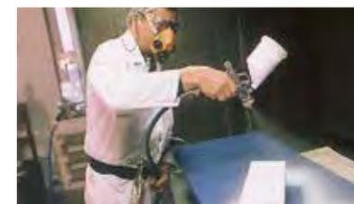
**4.** Füllen Sie die Fläche z. B. mit Wigranit® 2K-PUR Isolierfüller IF. Bei furnierten oder massiven Holzflächen würde hier gebeizt, grundiert oder gegebenenfalls fehlende Poren nachgezogen.
