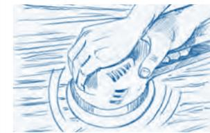
1. Bevor Sie mit dem Ölen beginnen, müssen Sie die Fläche, wie auf Seite 18 beschrieben, schleifen. Befreien Sie die Fläche anschließend vom Holzstaub.
