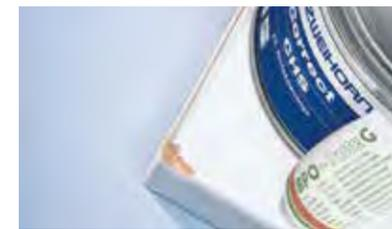
**1.** Kleben Sie die Ecke mit einem Klebeband ab. Mischen Sie den Correct 2K-Holzspachtel CHS mit der Härterpaste 100:3. Wichtig ist die Einhaltung des Mischungsverhältnisses und die homogene Vermengung von Spachtel und Härter.
