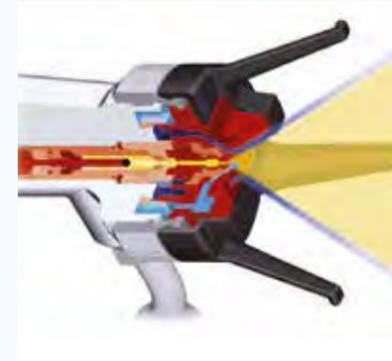
Der Lack wird durch Druckluft an der Düse zerstäubt (Foto: J. Wagner GmbH).
