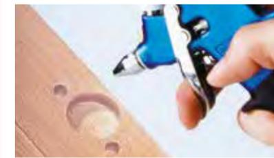
4. Die retuschierte Stelle muss nun mit dem „Original“-Klarlack (im Beispiel Crystallit® 2K-PUR Klarlack CL 8) „ansatzlos“ lackiert werden. Um ansatzfrei lackieren zu können, muss der Lack mit der maximalen Verdünnungszugabe appliziert werden (siehe Technisches Merkblatt unter [www.zweihorn.com](http://www.zweihorn.com)).
