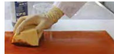
**Mit dem Schwamm:** Nehmen Sie für den Schwammauftrag einen weichen feinporigen Schwamm. Dieser wird zunächst leicht befeuchtet und anschließend mit der Beize getränkt. Der Auftrag erfolgt dann gleichmäßig und satt in Maserrichtung des Holzes. Der Schwammauftrag hat den Vorteil, dass große Flächen somit schnell und besonders ebenmäßig behandelt werden können.
