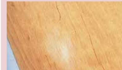
Scheuerstelle am Beispiel einer geölten Massivholzplatte
