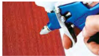
3. Zum Schutz der Weichwachs-Fläche sollten Sie die Stelle mit dem „Original“-Klarlack (im Beispiel Crystallit® 2K-PUR Klarlack CL 8) „ansatzlos“ lackieren. Um ansatzfrei lackieren zu können, muss der Lack mit der maximalen Verdünnungszugabe appliziert werden (siehe Technisches Merkblatt unter [www.zweihorn.com](http://www.zweihorn.com)).
