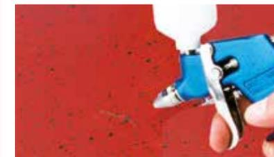
3. Die retuschierte Stelle muss nun mit dem „Original“-Klarlack (im Beispiel Crystallit® 2K-PUR Klarlack CL 8) „ansatzlos“ lackiert werden. Um ansatzfrei lackieren zu können, muss der Lack mit der maximalen Verdünnerzugabe appliziert werden (siehe Technisches Merkblatt unter [www.zweihorn.com](http://www.zweihorn.com)).
