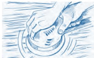
1. Bevor Sie mit dem Ölen beginnen, müssen Sie die Fläche, wie auf Seite 18 beschrieben, schleifen. Befreien Sie die Fläche anschließend vom Holzstaub. Algen, Fett, Schmutz und sonstige Verunreinigungen sollten mechanisch mit einem Pad, Schleifschwamm oder Schleifpapier entfernt werden. Bereits verwittertes Holz sollte ebenfalls gründlich abgeschliffen werden, bis es sein natürliches Aussehen zurückerhält.
