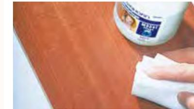
**2.** Sie sollten die Fläche anschließend noch von allen Verunreinigungen säubern. Wischen Sie die Oberfläche einfach mit Zweihorn® Möbelreiniger und -pflege MRP ab.
