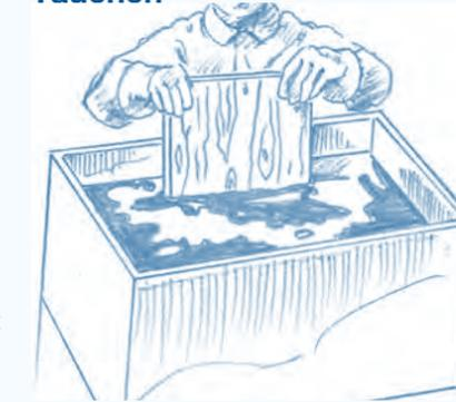
*Im Tauchverfahren können kleinere Werkstücke mit Lack, Lasur oder Öl beschichtet werden.*
