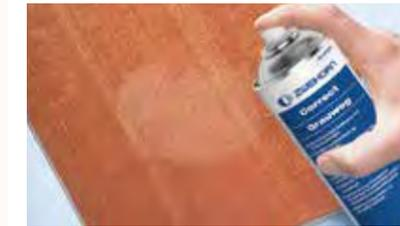
**1.** Wasserflecken als graue Stellen können durch Wasser selbst oder hohe Wasserdampfkonzentrationen bei nitrolackierten Flächen entstehen. Besprühen Sie einfach die Stelle mit Zweihorn® Grauweg und lassen es einwirken, bis die Stelle wieder trocken ist.
