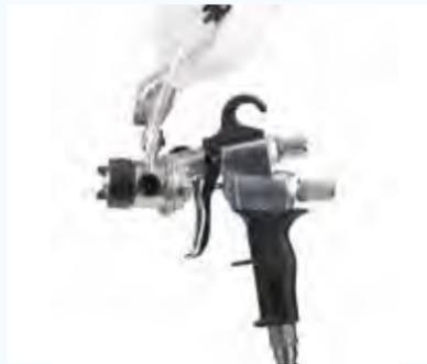
Dünn viskose Materialien werden allein durch die Schwerkraft und durch den Unterdruck an der Düse zerstäubt. Die Abbildung zeigt eine Fließbecherpistole mit der Möglichkeit eines Zusatzluftdrucks von oben für hoch viskose Materialien (Foto: Walter Pilot).
