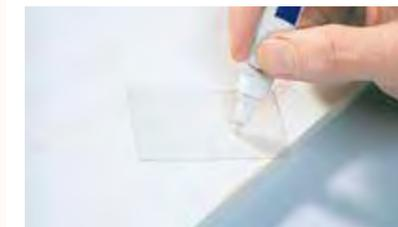
**1.** Nehmen Sie den Correct Deck- und Lasierstift CDLS in der richtigen Farbe. Diese können Sie sich bei Ihrem Händler im passenden Farbton mit sämtlichen Beizen und Buntlacken abfüllen lassen. Setzen Sie den Stift auf ein Abfallbrett o. Ä. und drücken ihn 3–4 Mal nach unten, bis sich die Spitze mit Farbe gefüllt hat. Nun ist der Stift einsatzbereit.
