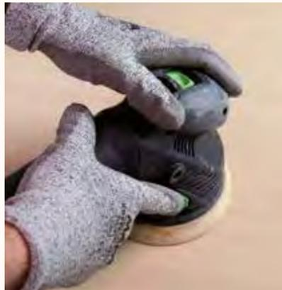
*Der Holzschliff mit einem Exzenterschleifer*
