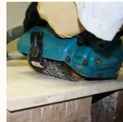
Bearbeitung des Weichholzes mit einer Handbürstmaschine
