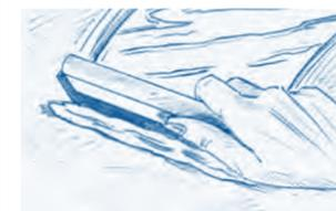
3. Nach einer Wartezeit von ca. 40–60 Minuten muss das überschüssige Öl komplett abgenommen werden! Ziehen Sie die Fläche hierzu am besten mit einem sauberen, nicht abfärbenden Gummirakel, Fensterwischer oder Tuchballen ab.
