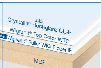
Natürlich ist auch der neue Wigranit® Top Color als Systemkomponente entwickelt worden. So kann der neue Wigranit® Top Color mit Crystallit®, Diadur® Plus oder Purolit ablackiert werden – **von tiefmatt bis hochglänzend**.
