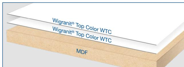
Das Produkt kann aufgrund der **guten Isolier- und Fülleigenschaften auf roher MDF** (auch in Feuchträumen wie Bad oder Küche) als Grund- und Überzugslack eingesetzt werden.
