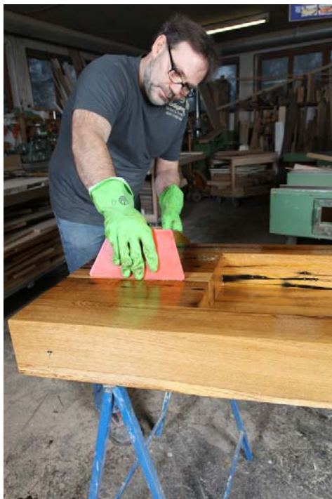
Nach der Einwirkzeit nimmt Rüdiger Abel das überschüssige Öl zuerst mit der Rake und anschließend mit einem Lappen ab. Foto: Akzo Nobel Wood Coatings GmbH - Geschäftsbereich Zweihorn
