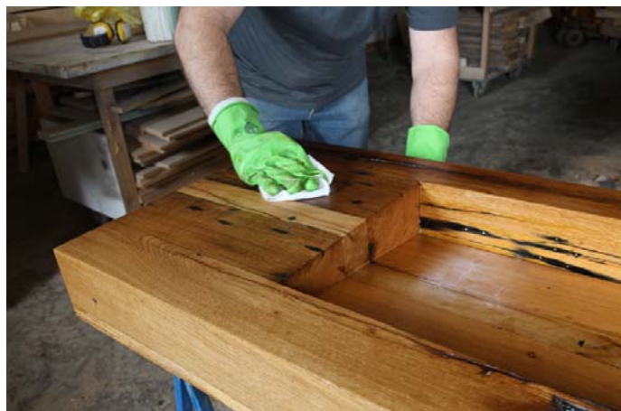
Nach der Einwirkzeit nimmt Rüdiger Abel das überschüssige Öl zuerst mit der Rake und anschließend mit einem Lappen ab. Foto: Akzo Nobel Wood Coatings GmbH - Geschäftsbereich Zweihorn
