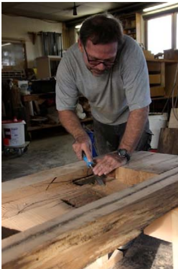
Aus Altholz fertigt Schreinermeister Rüdiger Abel in gekonnter Handarbeit das Waschbecken. Foto: Akzo Nobel Wood Coatings GmbH - Geschäftsbereich Zweihorn
