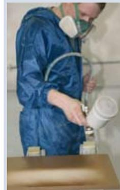
Anschließend trug der Lackierer zweimal, nach einem Zwischenschliff mit 220er bzw. 400er Korn, den Wigranit Isolierfüller auf.
